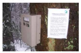
Die Abbildung oben zeigt eine Cuddeback Expert Trail Camera in einer so genannten "Bear Safe Box", eine sehr widerstandsfähige Metallbox. Die Metallbox erleichterte die Befestigung am Baum und bot zusätzlichen Witterungsschutz.
